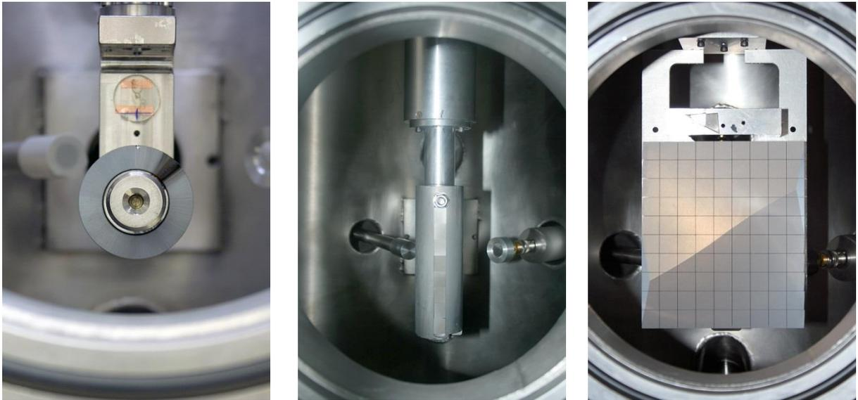
Figura 14 – fotografia de três porta amostra da câmara de JET
