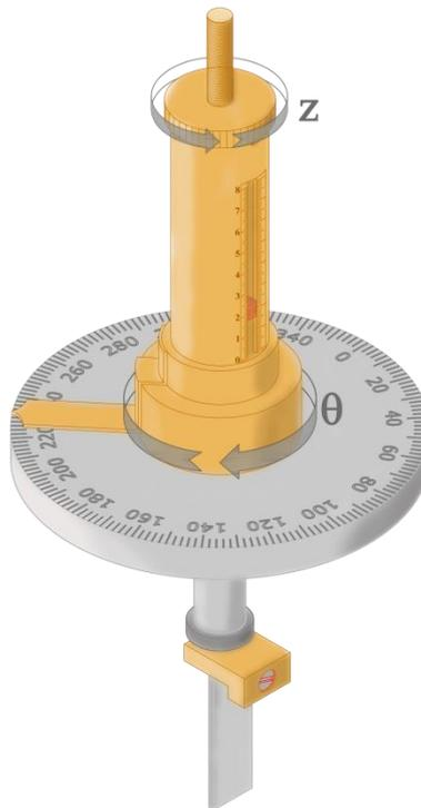
Figura 11 – posicionamento de uma amostra no Goniómetro de RBS.
