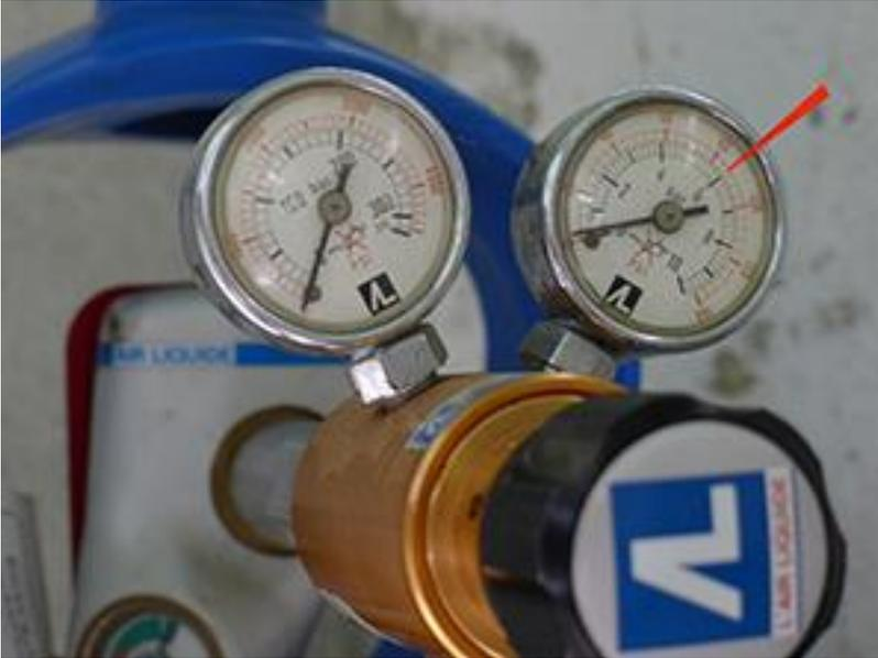
Abrir a garrafa de N2 e o manómetro desta até 6 bar de pressão ou até um valor ligeiramente superior! (Rodar o parafuso no sentido dos ponteiros do relógio)!
